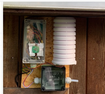
senseBox hängt auf Höhe 220cm an der Nordseite einer Gartenhütte aus Holz. senseBox is mounted 220cm above ground at the north side of a wooden garden hut.
